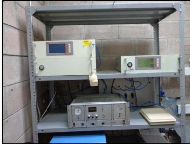
**Figura 2.2.10** Equipo de monitoreo de concentraciones de gas.
