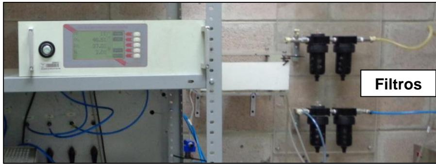
Figura 5.2.3 Analizador de emisiones de metano con filtros.
