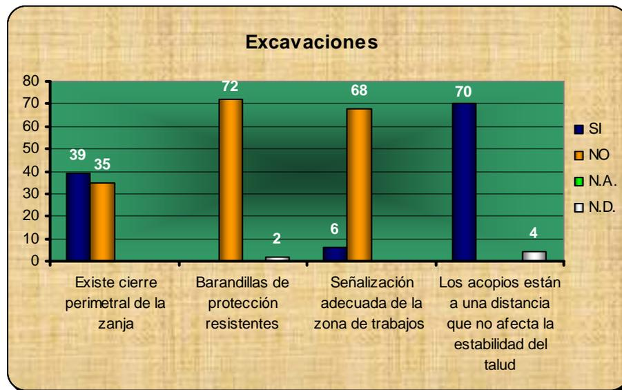
En los trabajos de excavaciones pudo apreciarse un riesgo de caída dentro de una zanja por la falta de barandillas de protección y es que un 97% no disponen de elementos que resguarden a las personas de sufrir caídas dentro de excavaciones. Otro punto importante es que los acopios no se encuentren cerca de la excavación ya que el peso de éstos junto con vibraciones de maquinaria y vehículos en marcha puede propiciar derrumbes y soterramientos, un 94% cumplió con esta disposición.
